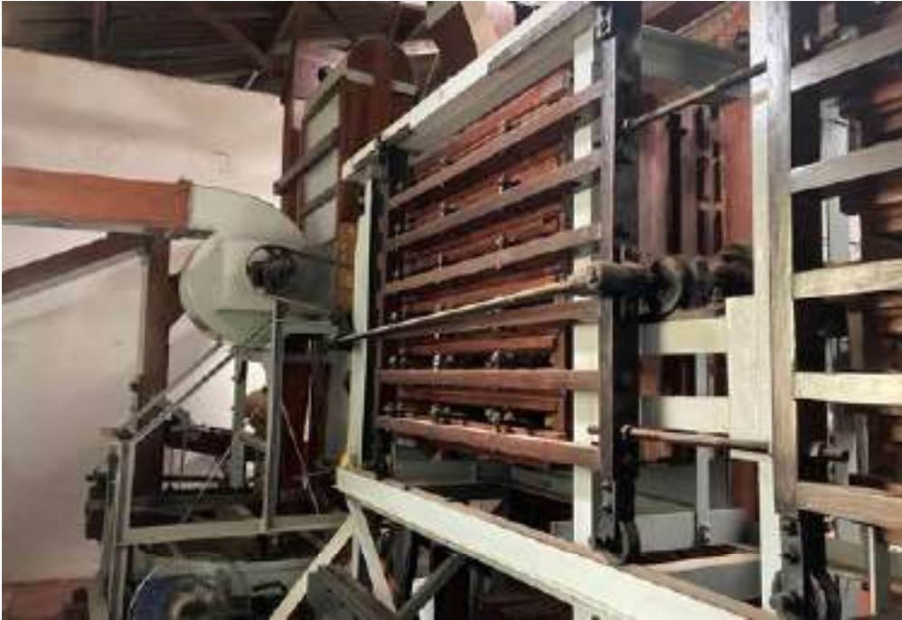
Figura 5. Classificador de café na casa de máquinas refuncionalizada como loja e restaurante.
