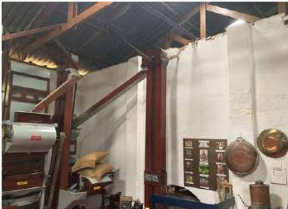
Figura 6. Descascador, catador de impurezas e elevador na casa de máquinas refuncionalizada como loja e restaurante.
